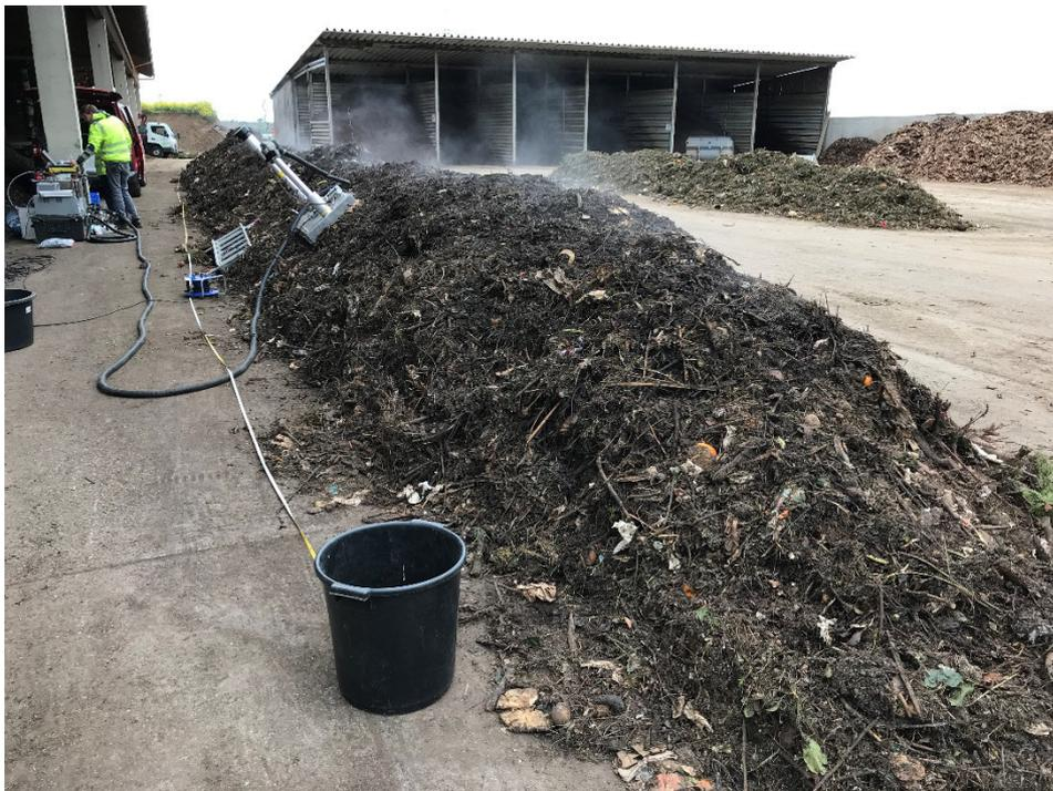
Bild 2: Miete mit Wasserdampf über der Mietenkrone und Meßhaube an der Flanke (Tag 4, 16.05.2019)
