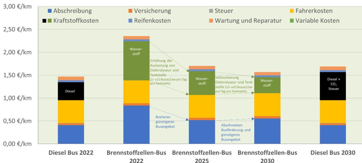
**Kostenentwicklung** von Brennstoffzellen-Regional-Bussen mit grünem Wasserstoff aus der HyBayern-Region im Vergleich mit Dieselbussen: Die Kostenparität zwischen Brennstoffzellen-Regionalbussen und Dieselbussen in der HyBayern-Region ist bis 2030 erreichbar (Hynergy ©2021; Datenquelle: Kostenberechnungen im Projekt HyBayern)
