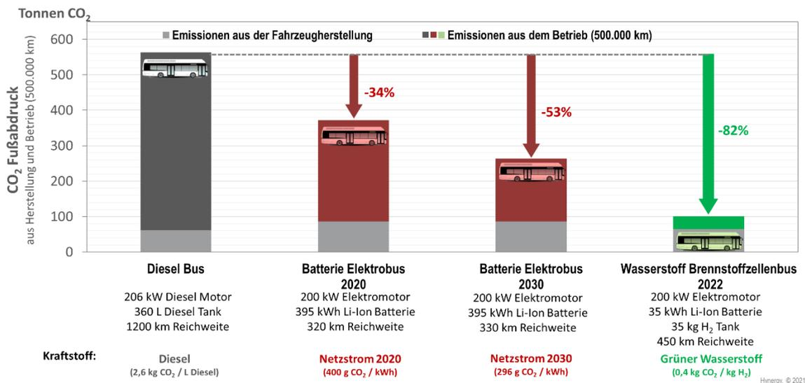
**CO<sub>2</sub>-Vorteil** von Brennstoffzellen-Regional-Bussen mit grünem Wasserstoff: Aktuell sind drei bis vier Batterie-Elektrobusse mit Ladesäulen am deutschen Stromnetz nötig, um den CO<sub>2</sub>-Vorteil eines Brennstoffzellen-Busses mit grünem Wasserstoff zu erreichen (Hynergy ©2021; Datenquelle: Fraunhofer ISE „TREIBHAUSGAS-EMISSIONEN FÜR BATTERIE- UND BRENNSTOFFZELLENFAHRZEUGE MIT REICHWEITEN ÜBER 300 KM“)
